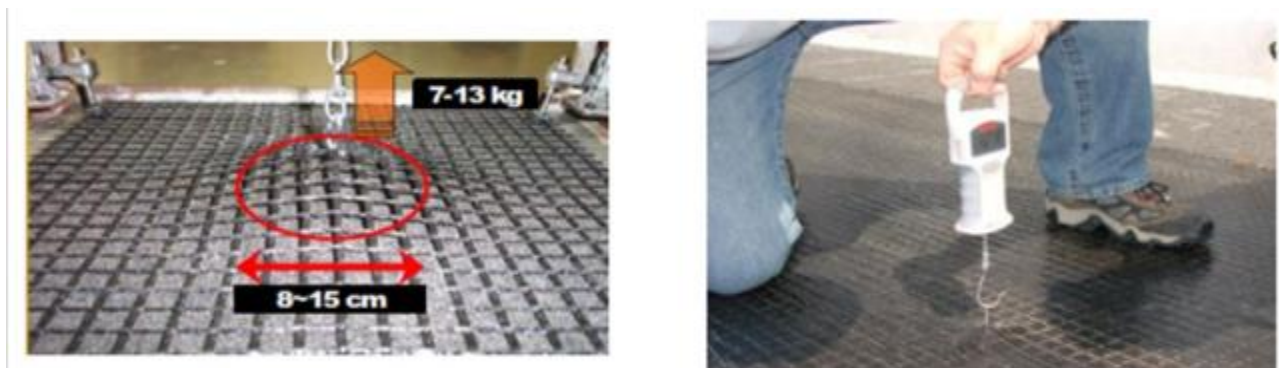
Hình B.1 - Đánh giá khả năng dính bám giữa lưới sợi thủy tinh và lớp móng bằng cân lò xo
